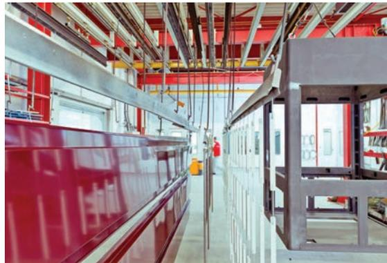
Der Lack von Industrieteilen und Maschinen muss ganz schön was aushalten: Hitze, Kälte, Hagel, Steinschlag usw. Damit der Lack hält und er das darunter liegende Material schützt, wählt der Verfahrensmechaniker für Beschichtungstechnik die unterschiedlichsten Farbtöne, Glanz- und Härtegrade der Lacke aus. Je nach Untergrund, z.B. Holz, Kunststoff oder Metall wird der Lack mit der geeigneten Technik aufgetragen.
